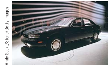
Figura 9.27 Una ilustración de las líneas de corriente alrededor de un automóvil en una prueba en un túnel de viento. Las líneas de corriente en el flujo de aire se hacen visibles con partículas de humo.
