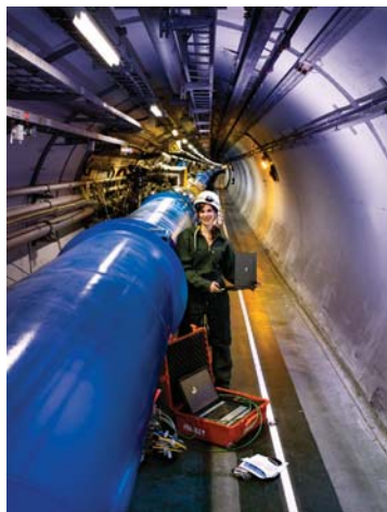
Un ingeniero prueba la electrónica asociada a un imán superconductor en el Gran Colisionador de Hadrones en el Laboratorio Europeo de Física de Partículas, dirigido por el CERN. (El acrónimo de Conseil Européen pour la Recherche Nucléaire, y se ha mantenido a pesar de que “Conseil”, o “Consejo”, ha sido sustituido por “Organización”.)
