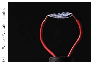
Figura 16.25 Rompimiento dieléctrico en aire. Las chispas se producen cuando un gran voltaje alterno se aplica a través de los alambres mediante una fuente de poder con bobina de inducción de alto voltaje.
