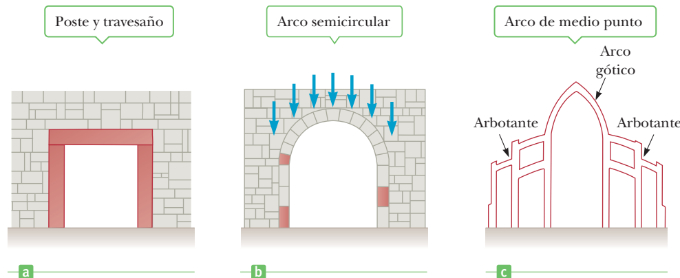
Figura 9.11 a) Una estructura de simple poste-travesaño. b) El arco semicircular desarrollado por los romanos. c) Arco gótico con arbotantes volados para proveer soporte lateral.
