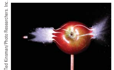
Figura 6.2 Una manzana está siendo perforada por una bala calibre 30 viajando con una rapidez supersónica de 900 m/s. Esta colisión fue fotografiada con un estroboscopio de micro destello utilizando un tiempo de exposición de 0.33 \mu\text{s} . Brevemente después de que se tomó la fotografía, la manzana se desintegró por completo. Observe que los puntos de entrada y salida de la bala son visiblemente explosivos.
