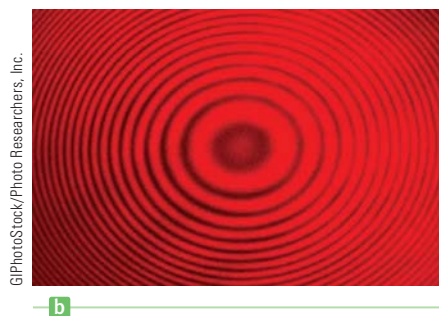
Figura 24.8 a) La combinación de rayos reflejados de la placa de vidrio y la superficie curva de la lente da lugar a un patrón de interferencia conocido como anillos de Newton. b) Fotografía de anillos de Newton. c) Este patrón de interferencia asimétrico indica imperfecciones en la lente.
