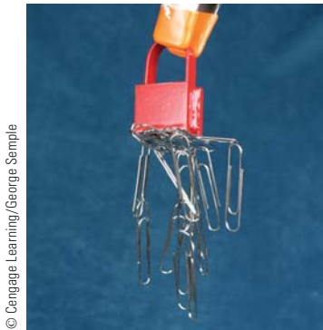
Figura 19.39 El imán permanente (rojo) magnetiza temporalmente algunos sujetapapeles, que entonces escalan uno sobre otro mediante fuerzas magnéticas.
