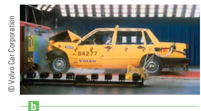
Figura 6.4 (Ejemplo 6.2) a) Esta cantidad de movimiento del automóvil cambia como resultado de su colisión con el muro. b) En una prueba de choque (una colisión inelástica), gran parte de la energía cinética inicial del automóvil se transforma en la energía tomada para dañar el vehículo.
