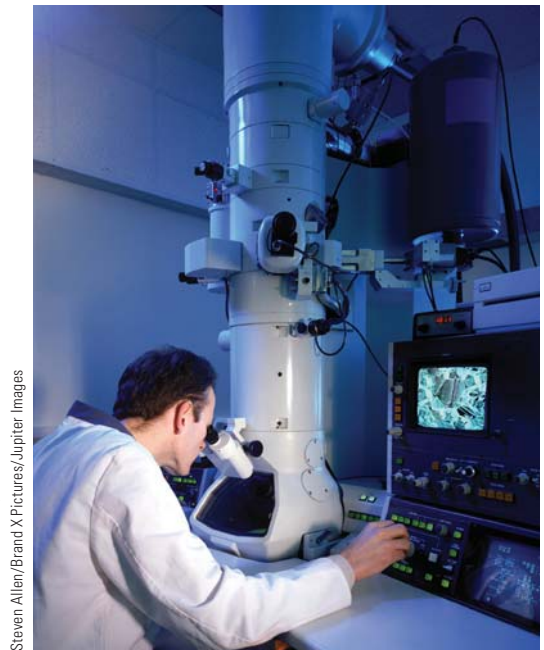
Figura 27.17 a) Diagrama de un microscopio electrónico de transmisión para ver una delgada muestra seccionada. Las “lentes” que controlan el haz de electrones son bobinas de desviación magnéticas. b) Microscopio electrónico.
