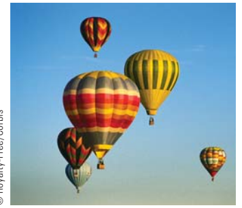
Globos de aire caliente. Debido a que el aire caliente es menos denso que el aire frío, hay una fuerza neta ascendente sobre los globos.
