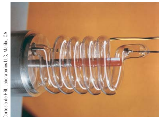
Figura 28.21 a) Pasos en la producción de un haz de láser. b) Fotografía del primer láser de rubí, que muestra la lámpara de destello que rodea la barra de rubí.
