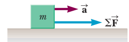
Figura 4.5 La segunda ley del movimiento. Para el bloque de masa m , la fuerza neta \Sigma\vec{F} actúa sobre el bloque es igual a la de masa m multiplicada por la aceleración de un vector \vec{a} .
